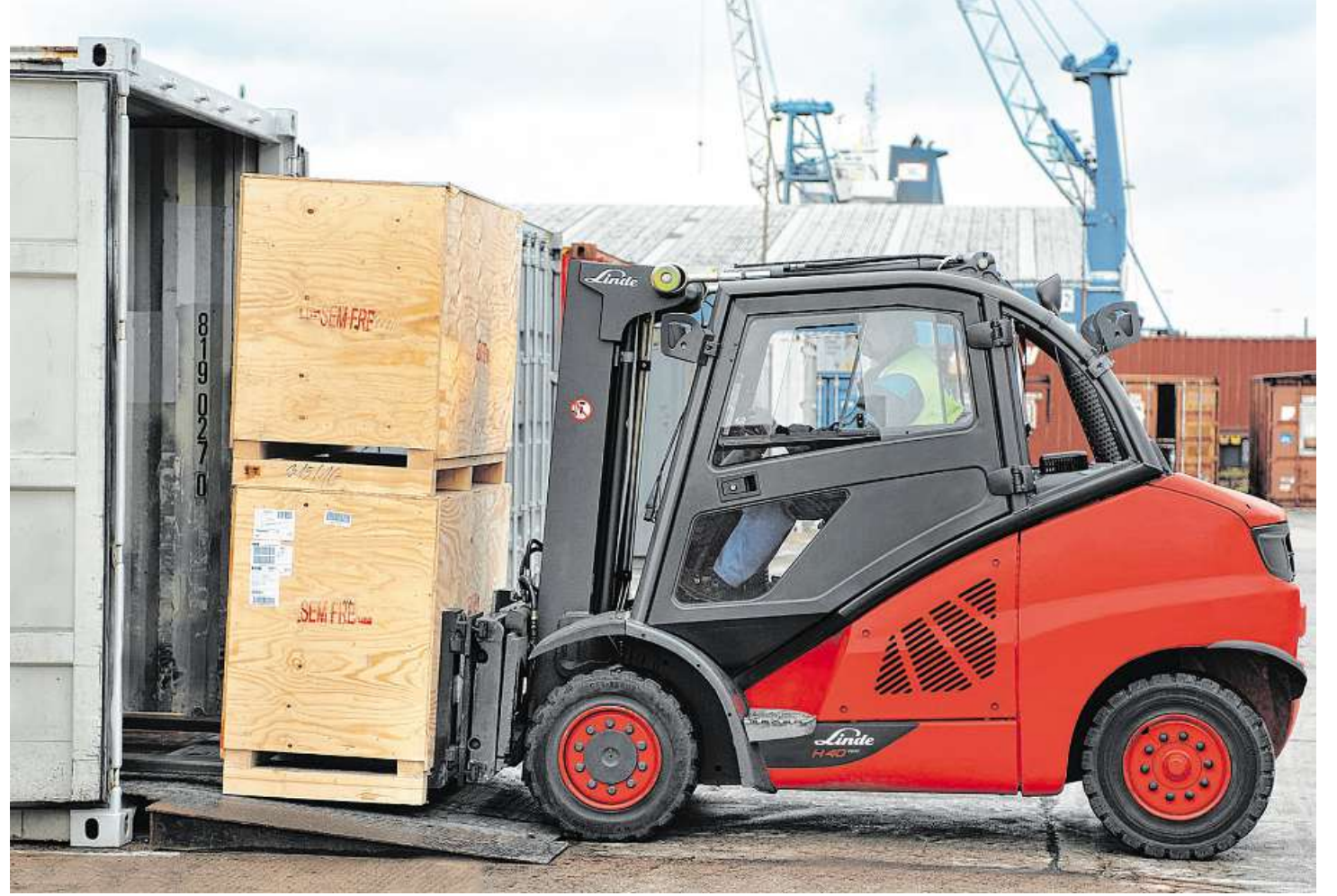
Das System Container hat sich weltweit durchgesetzt. Es funktioniert aber deshalb nur so gut, weil das Beladen der Blechbox nicht per Hand erfolgt, sondern dafür der Stapler eingesetzt wird. FOTO: LINDE MATERIAL HANDLING
