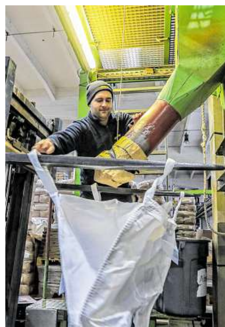
Die fertige Mischung landet aus dem Silo in großen Säcken.
